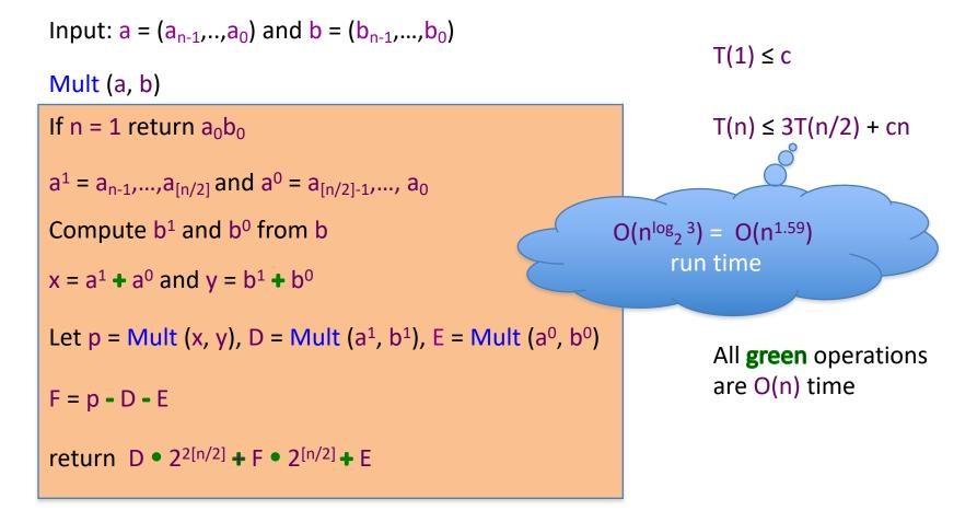
$a \bullet b = a^{1}b^{1} \bullet 2^{2[n/2]} + ((a^{1}+a^{0})(b^{1}+b^{0}) - a^{1}b^{1} - a^{0}b^{0}) \bullet 2^{[n/2]} + a^{0}b^{0}$
